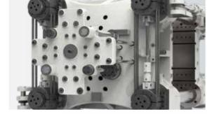
同步缓冲抱合机构,实现抱合同步,确保抱合快速、 可靠、静音
