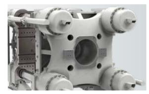
安装在定模板上的四个短程锁模油缸可快速建立锁模力,模具受力均匀,锁模力通过压力传感器可实时监控,锁模力重复再现性好
