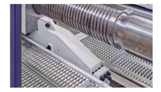
高刚性二板滑脚和机身底面与侧面导向机构,确保即 使安装重型模具,也能保持动模板的运动精度
